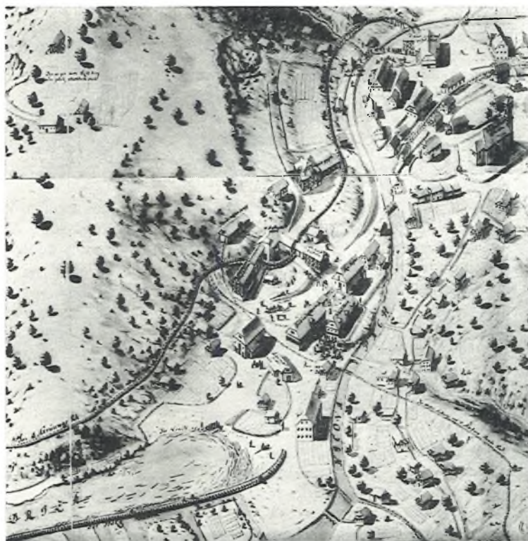
Pogled na del idrijskih vodnih pogonov, rudniških objektov in drugih stavb. Levo spodaj grablje z nakopičenimi hlodi; nad Idrijo peljejo rake vodo na kolesa (kamšči), ki obračajo vitle. V desnem zgornjem voglu cerkev sv. Barbare, zaščitnice rudarjev. Idrijska odtoka skozi grablje proti spodnjemu robu slike, v isto smer tudi Nikova. Zanimivost: risba je brez merila
