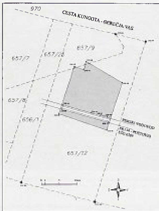
Kungota pri Ptuj, parc. št. 657/12 k. o. Gerečja vas. Pozicija izkopa ta temelje stanovanjske hiše in najdbe dela rimskega vodovodnega kanala Fram - Poetovio. Geodetski posnetek: Merilo d. o. o. Ptuj; rač. obdelava: Ivo Bizjak.
